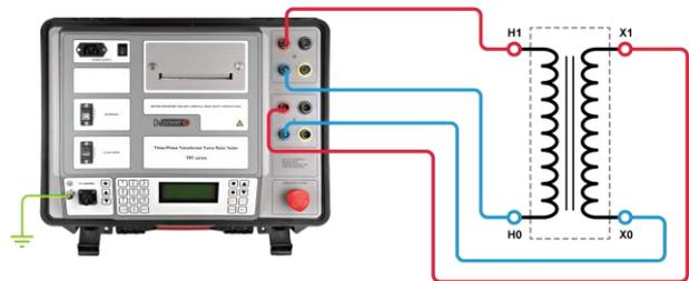
Conexión de TRT a transformador monofásico
