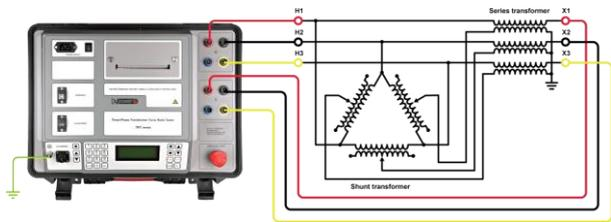
Conexión de TRT a transformador desfasador
