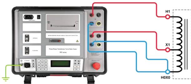
Conexión de TRT a autotransformador monofásico
