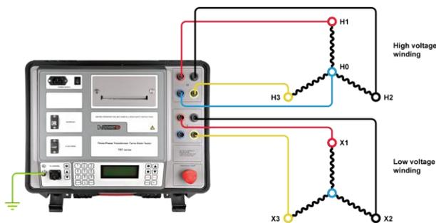
Conexión de TRT a transformador trifásico
