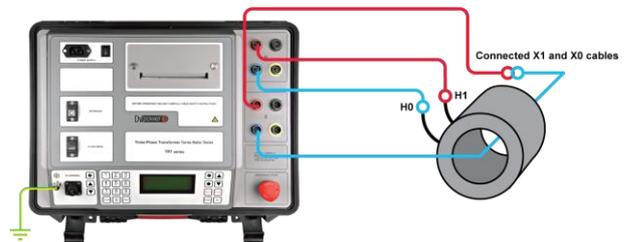
Conexión de TRT a un transformador de corriente amontado
