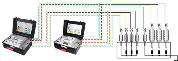
*Conexión de TRT Standard y TWA Standard a un transformador*
