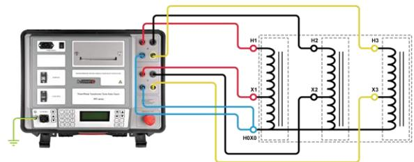
Conexión de TRT a autotransformador trifásico
