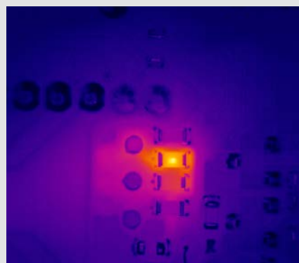
Grabación de una placa de circuito con el optris PI 640
