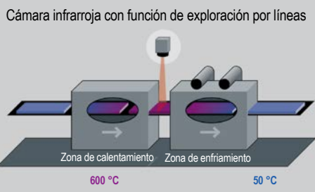
Construcción de una planta de templado de vidrio.
