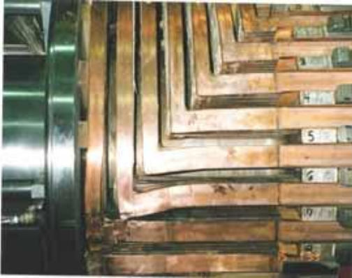
Figura 1: La elongación ha distorsionado la vuelta superior de la espira #6 ocasionando un contacto con la vuelta superior de la espira #7 (Corto de espira-espira).
